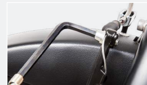
Figuur 12: Montage Remkabel
